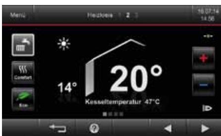
5-Zoll-Farb-Touch-Display der Regelung Vitotronic 200 (Typ HO2B)
